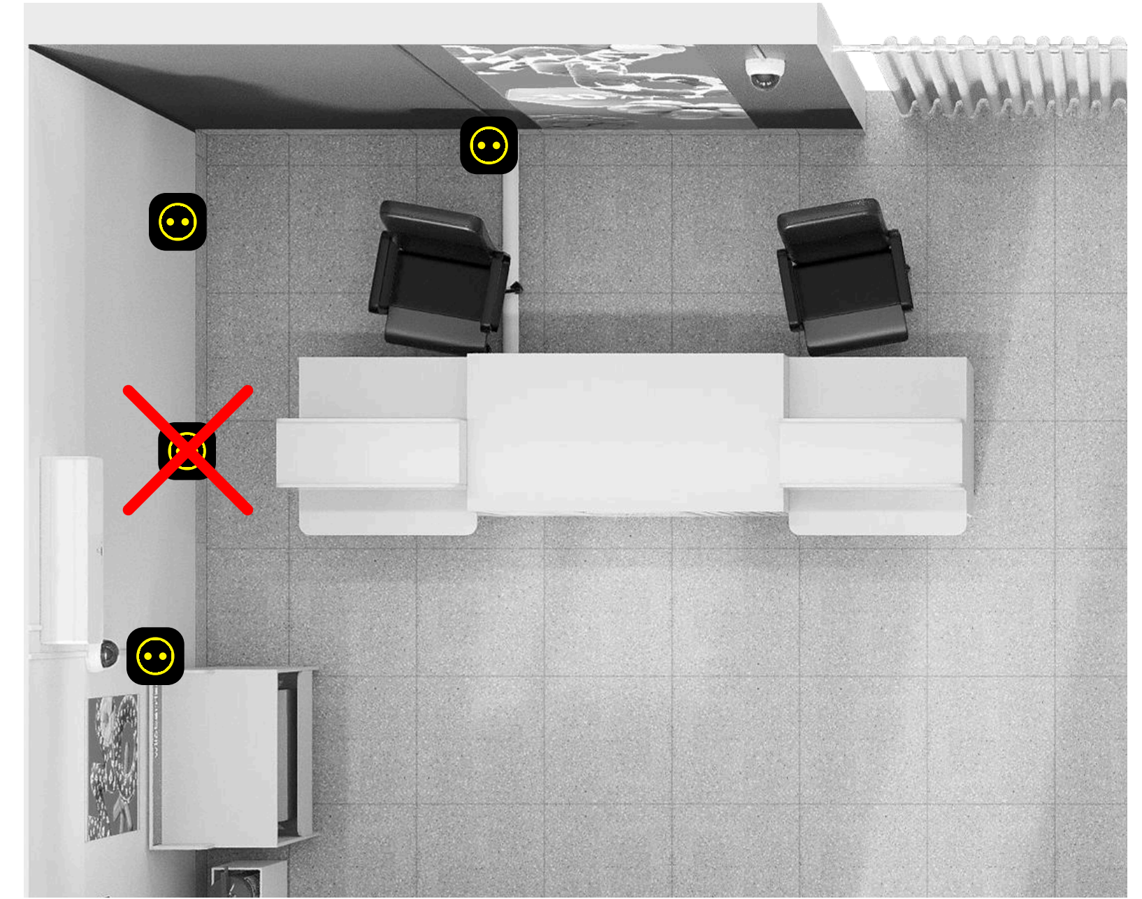
Открытая электрика с пола
